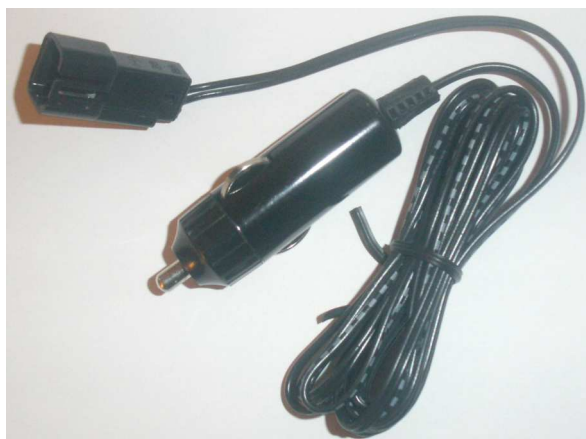
Faisceau de déblocage de la direction
